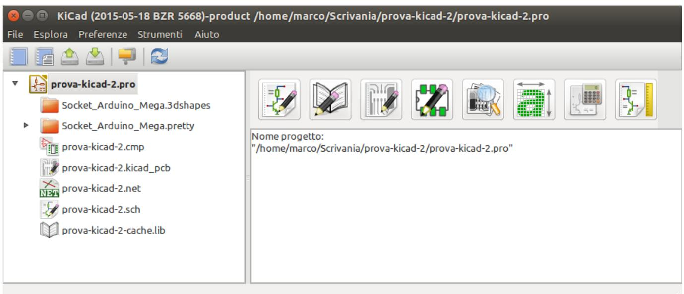
La finestra principale di KiCad è composta da una vista ad albero del progetto, un pannello di avvio contenente i pulsanti da usare per eseguire vari strumenti software e una finestra messaggi. Il menu e la barra degli strumenti possono essere usati per creare, leggere e salvare file di progetto.
